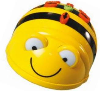
Tramite i tasti numerici possiamo far muovere Pro Bot come vogliamo, impostando la distanza da percorrere – da un centimetro a 5 metri – e l'angolo di rotazione, fino a 500 gradi. I comandi vengono visualizzati e memorizzati su un display: a quel punto basterà premere il tasto GO e la nostra macchina robot si metterà in moto. Premendo invece il tasto RPT l'operazione verrà ripetuta.
