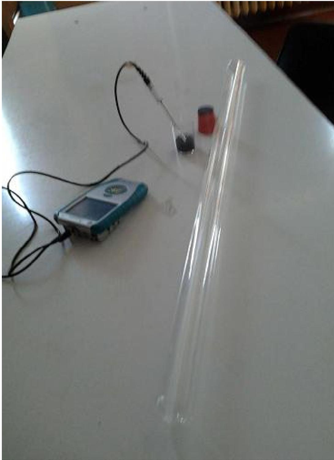
Le misure non sono molto precise; in particolare la proporzionalità tra il numero di cadute e l'aumento di temperatura dei pallini è ben soddisfatta all'inizio, un po' meno quando ci si discosta di più dalla temperatura ambiente.
