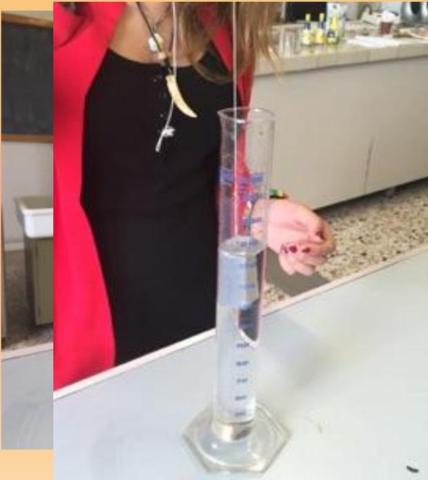
4) Si registra l'altezza dell'acqua dopo l'immersione del solido e si calcola il volume del peso come:
