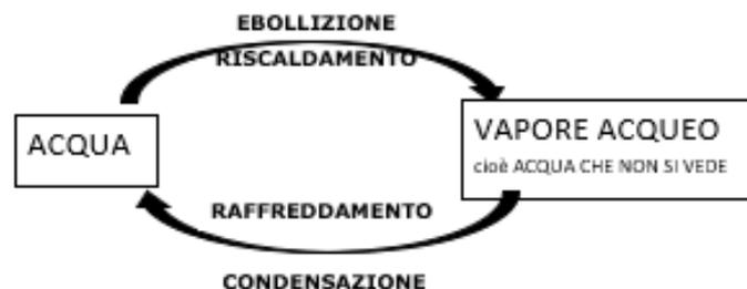
L'acqua, attraverso l'ebollizione si trasforma in vapore acqueo (cioè acqua che non si vede), poi, passando dal tubo refrigerante si raffredda e torna visibile sotto forma di acqua. Quest'ultima trasformazione si chiama
