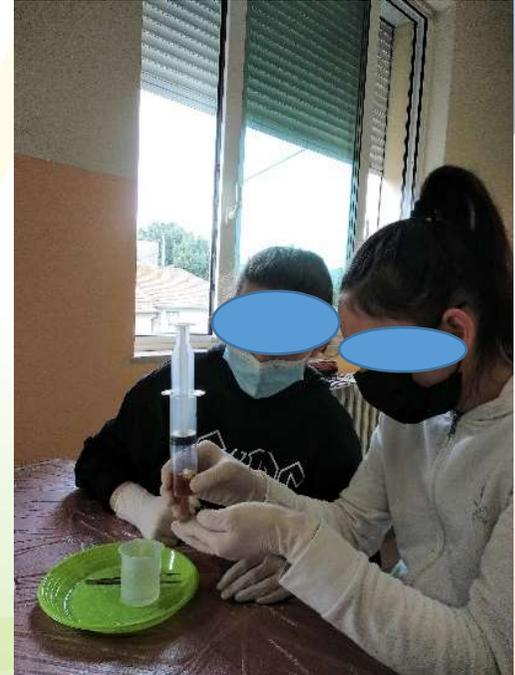
La siringa si scalda, il liquido diventa giallo-arancio e il pistone si sposta verso l'alto rivelando la formazione di un gas. Si svuota velocemente il liquido dalla siringa (esce con notevole pressione) e si trattiene il gas all'interno. Come l'esperimento precedente si verifica la formazione di ossigeno sempre tramite bastoncino.
