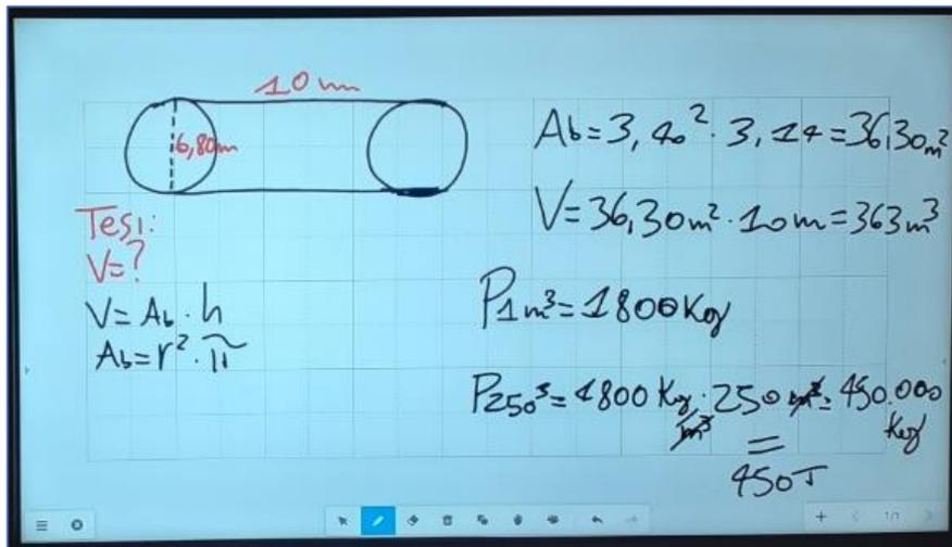
Partendo dal dato: «ogni  $m^3$  di terra pesa 1800 Kg», si definisce **il peso specifico come il peso del volume unitario**, e si scrivono le unità di misura più utilizzate:  $Kg/m^3$  e  $g/cm^3$
