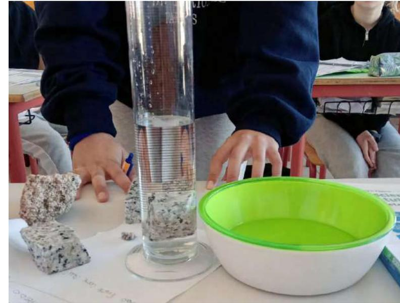
PESO GRANITO = 83g       $V_{H_2O} = 200 \text{ cm}^3$        $V_{H_2O+R} = 230 \text{ cm}^3$
