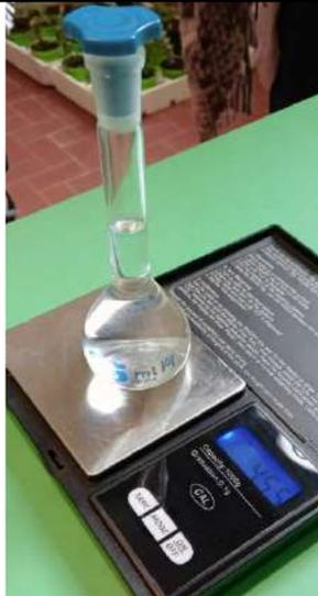
Poi i due liquidi nei matracci sono stati pesati, determinando un peso di **44,8 g per l'olio** e di **45,5 g per l'acqua distillata** (vedere il disegno di Teresa in basso).
