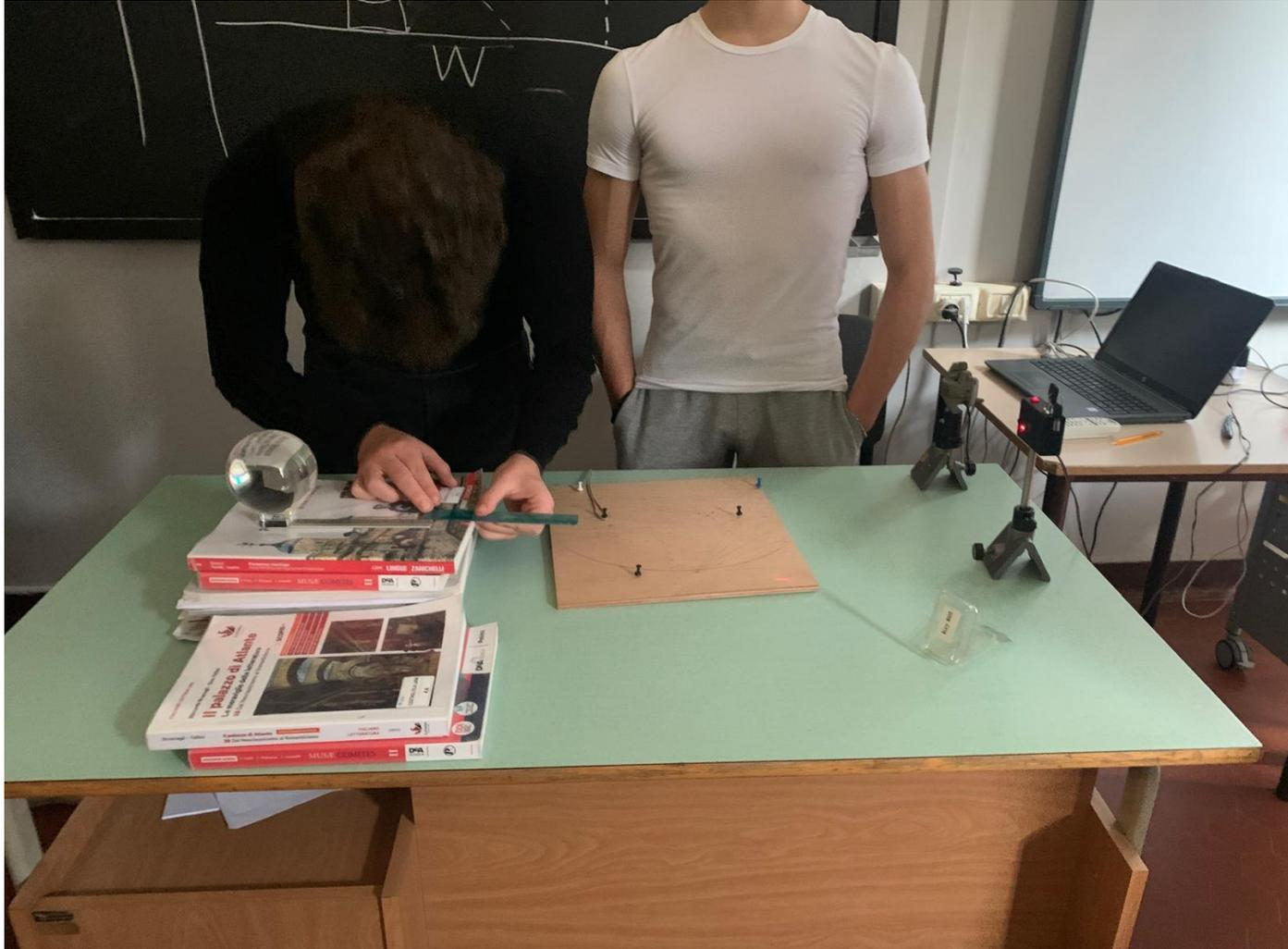
Si cerca una relazione tra l'altezza del raggio incidente e l'angolo del raggio riflesso, che viene ricavata (in maniera approssimata) dalla distanza del puntino luminoso che si forma sul piano orizzontale
