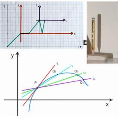
È possibile determinare la velocità media in intervalli di tempo sempre più piccoli, calcolando il coefficiente angolare di rette secanti il grafico  $s_1, s_2, s_3, s_4 \dots$  come indicato nel grafico.
